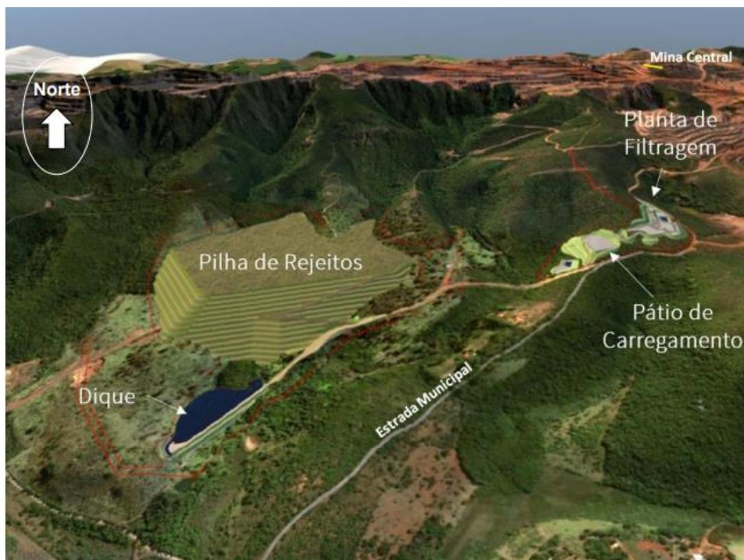
Figura 5-1 – Representação 3D do arranjo geral do Sistema de Disposição de Rejeitos Filtrados - SDRF
