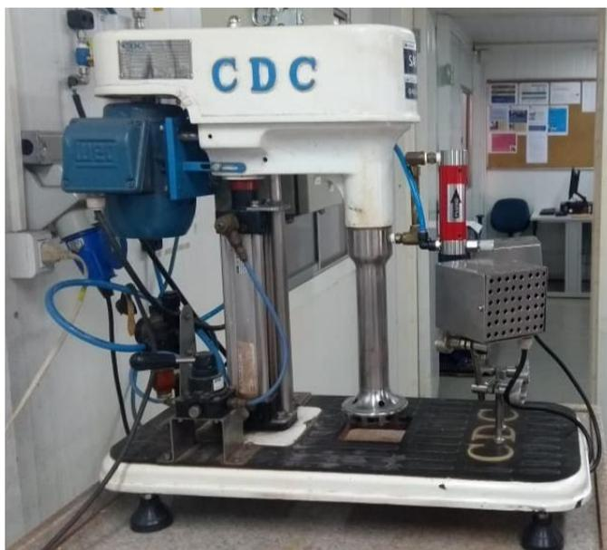
Figura 4.8: Foto célula de flotação CDC
