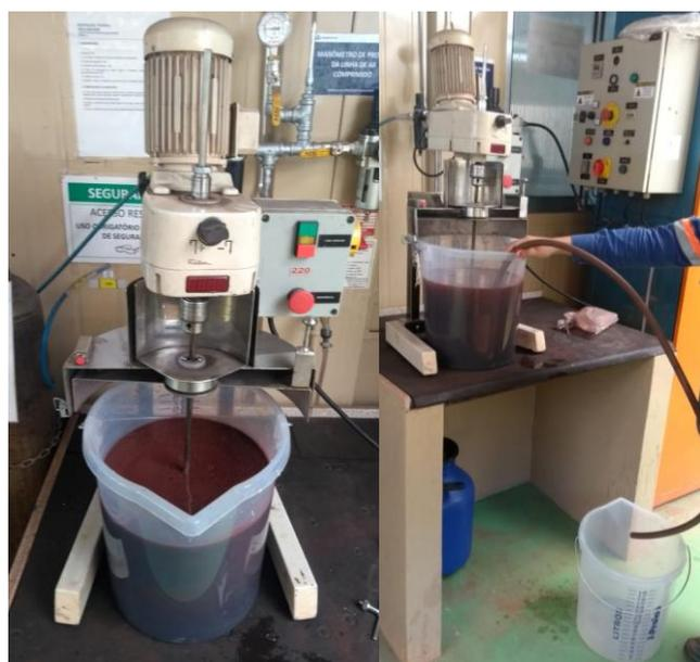
Figura 4.7: Foto do sistema de deslamagem
