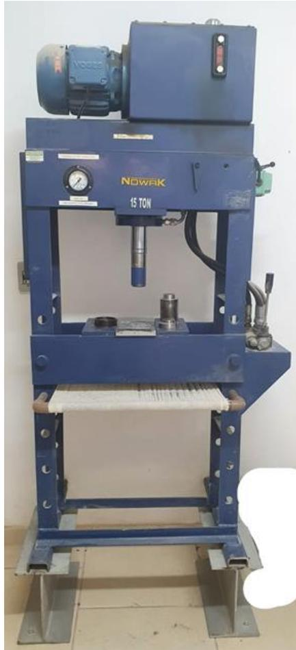
FIGURA 4.12 - Prensa hidráulica Nowak
