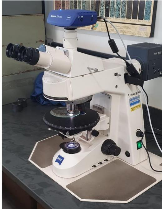
FIGURA 5.1 - Microscópio Axioskop 40 Zeiss com câmera Axiocam 208 color ZEISS acoplada na parte superior
