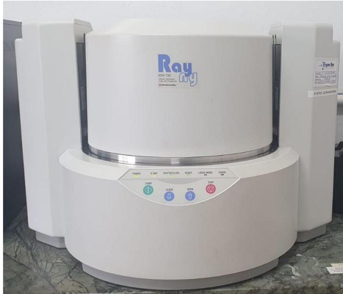
FIGURA 4.10 - Equipamento da marca Shimadzu modelo EDX-720 utilizado
