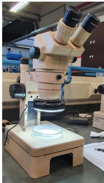
FIGURA 4.8 - Microscópio de lupa binocular Olympus (80X) utilizado para determinação do grau de liberação do dunito serpentinizados
