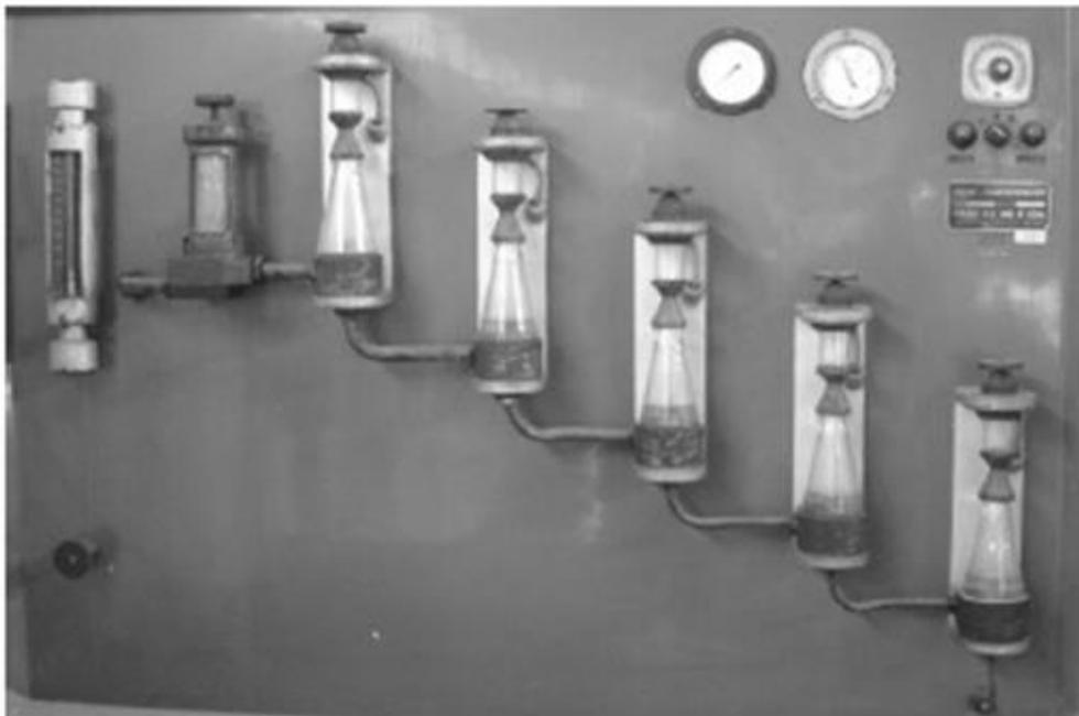
FIGURA 3.6 - Cyclosizer Warman possui hidrociclones invertidos em série
