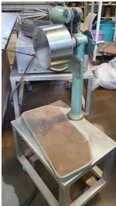
FIGURA 4.5 - Separador magnético tipo LIMS de baixa intensidade
