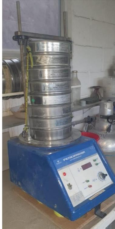
FIGURA 4.1- Peneirador vibratório de bancada utilizado
