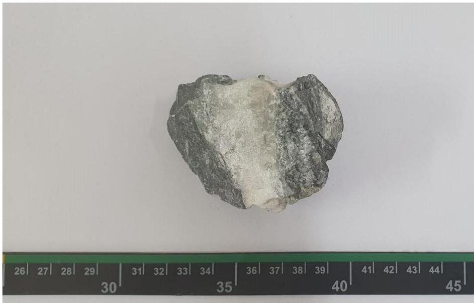
FIGURA 3.3 - Amostra de metapiroxênito, decorrente do estado de Minas Gerais, oriundo da serpentinização de piroxênios.
