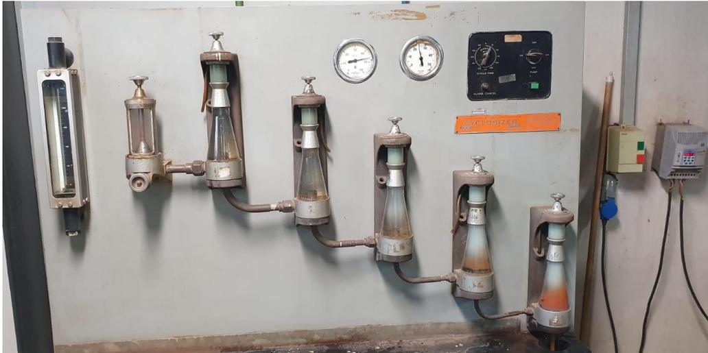
FIGURA 4.3 - Cyclosizer em funcionamento separando os finos do metapiroxênio
