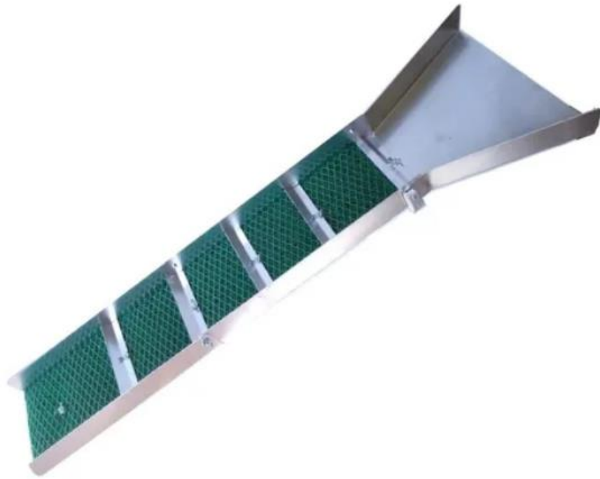
Figura 12 - Calhas concentradoras usada em garimpo de ouro (MERCADO LIVRE, 2022).
