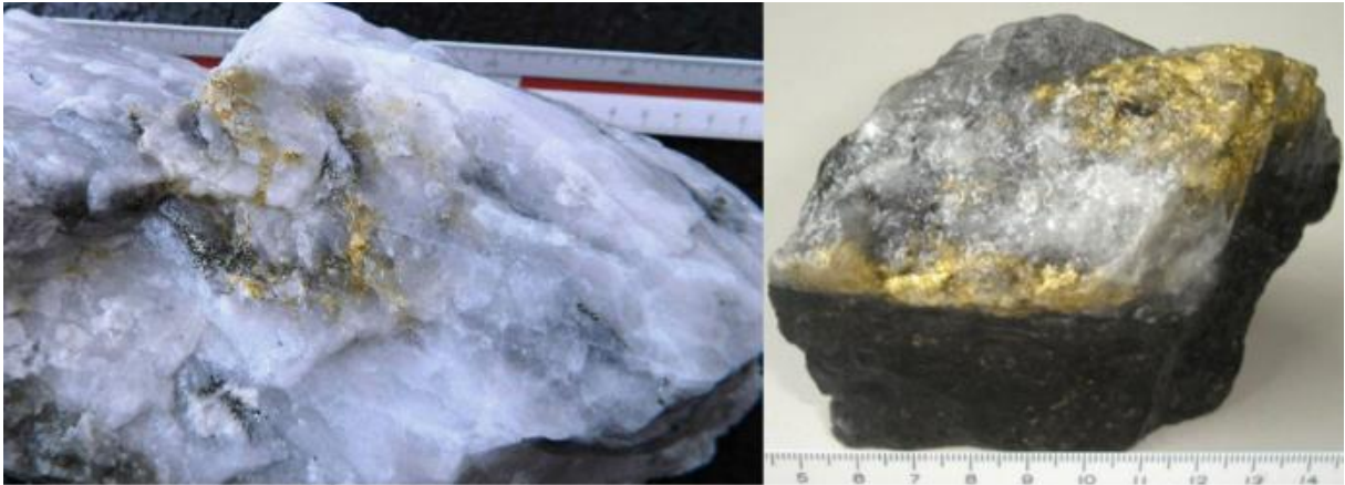
Figura 1 - Ouro em veios de quartzo das minas Engenho d'Água e Catita, região do Quadrilátero Ferrífero (LOBATO, L. M.; COSTA, M. A. OURO, 2020.)
